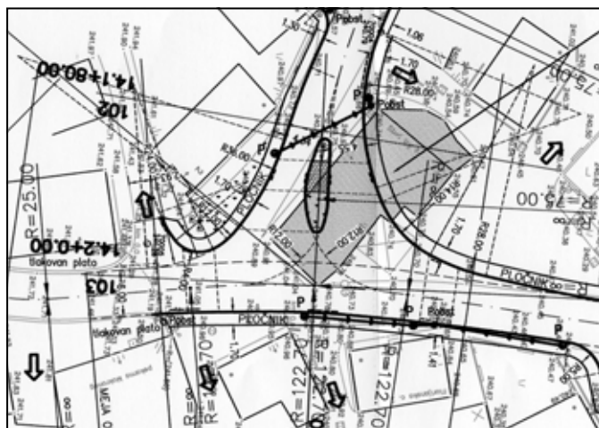
Slika 1: Ureditev križišča v obliki črke T, izsek iz idejnega projekta (IDZ št. 1357) ureditve križišča v Mokronogu na R!-215, odsek 1163 Trebnje-Mokronog-Boštanj, km 0.000. Izdelovalec: Projektivni biro Lunar d.o.o. iz Kranja.
